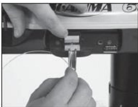
Чтобы измерить длину струны, подаваемой с рейки или с отдельного мотка, вставьте конец струны в петлю на задней части измерителя. Поднимите зажим и вставьте струну в отверстие ввода на фронтальной части измерителя. Протягивайте струну через входное отверстие, пока она не покажется из отверстия справа, затем опустите зажим. (Вместе со струной можно зажать небольшой кусок войлока - это снизит нагрузку на струну и предотвратит попадание мелкого мусора в измеритель длины).
