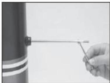
Рейка держателя струны представляет собой проволоку диаметром 8 мм с утолщениями на обоих концах и плоским спилом на одном из концов. Поместите конец проволоки без спила в специальное отверстие на нижней колонне. Работая гаечным ключом М6 по плоской поверхности проволоки, надежно закрепите ее на нижней колонне.
