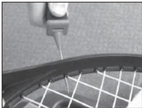
Комплект поставки включает в себя специальное шило для натяжки струн, которое можно вставить в зазор между струной основы и отверстием в ободе ракетки. Использование этого инструмента упрощает и ускоряет процесс натяжки поперечных струн. Перед вводом шила в обод ракетки не забудьте закрыть в нем отверстие, предназначенное для струны.
