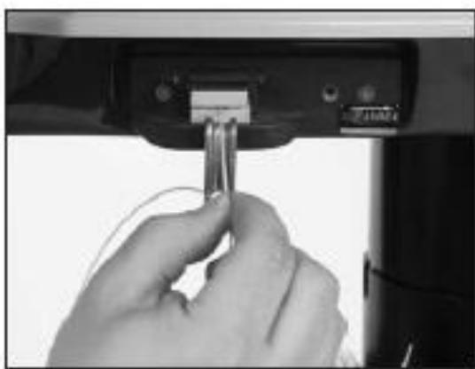
Когда конец струны покажется из отверстия справа, нажмите кнопку "C" или "Enter/Clear" на клавиатуре (в это время на дисплее будет надпись "0"). Длина струны будет измеряться от свободного конца струны до выходного отверстия. Начните медленно и равномерно вытягивать струну, и измеритель начнет свою работу. По мере протяжки струны будут меняться показания на дисплее. Когда будет отмерена желаемая длина, отрежьте струну в районе выходного отверстия.
